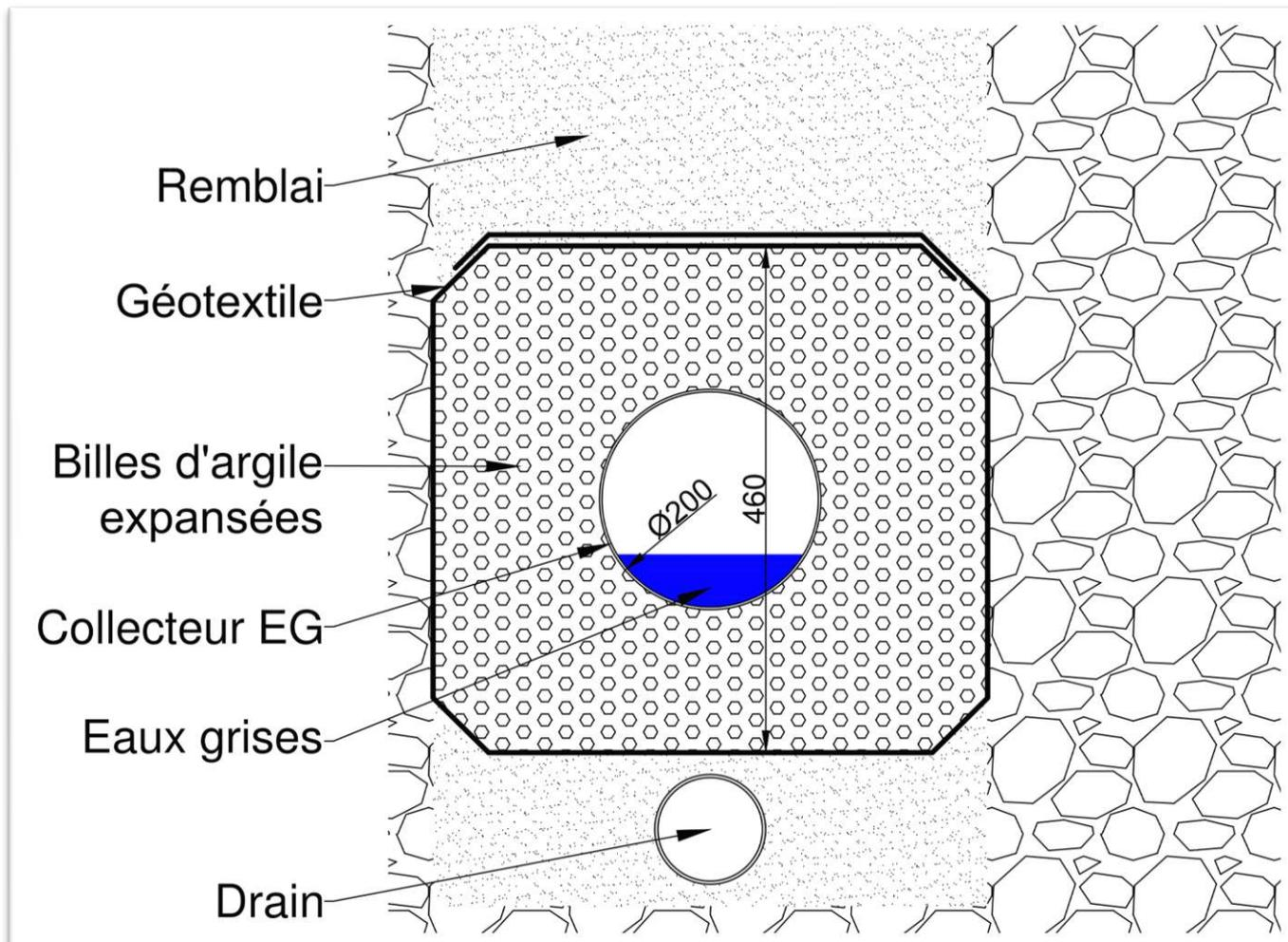
Figure 6 : Exemple de vue de coupe d'un collecteur enterré calorifugé par billes d'argile expansées
