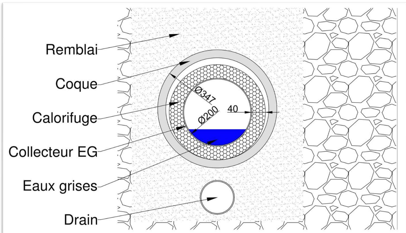
Figure 5 : Exemple de vue de coupe d'un collecteur enterré calorifugé par elastomère
