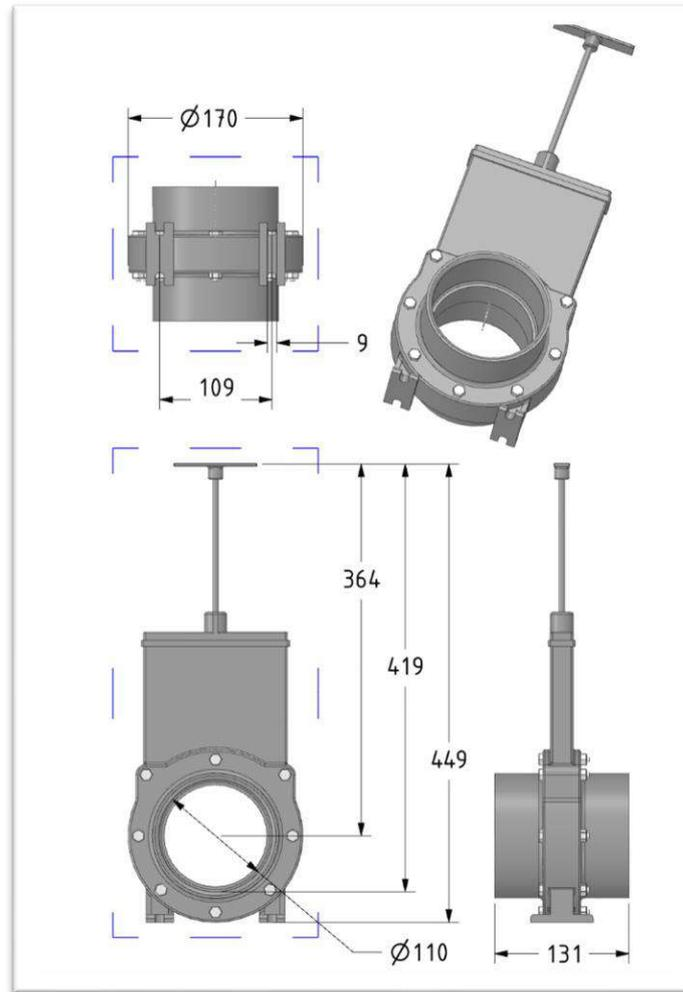
Figure 1 : Dimensions de la vanne guillotine DN110
