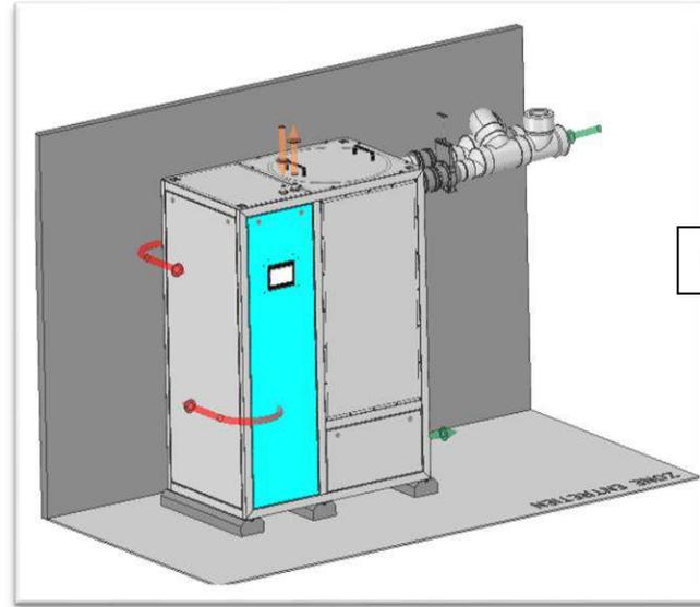
L'ERS Compact est livré par défaut dans le montage de droite. Il est possible de placer la machine dans l'autre sens en échangeant la façade de l'écran tactile avec la façade opposée. Cette opération est effectuée en usine ou par Biofluides sur site si nécessaire (avant le raccordement électrique et à condition que les façades soient suffisamment éloignées du mur).
