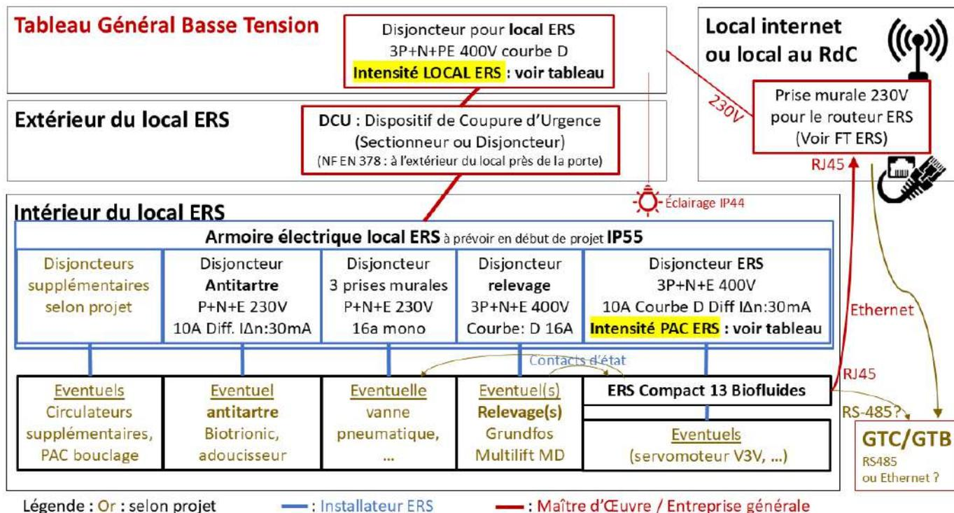
Figure 4: Illustration de l'alimentation électrique type
