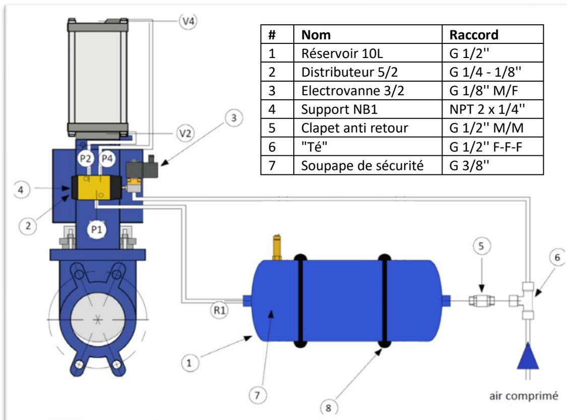
Raccordements de vanne à guillotine pneumatique simple effet normalement fermée par manque de courant : P1 sur R1, P2 sur V2, P4 sur V4.
